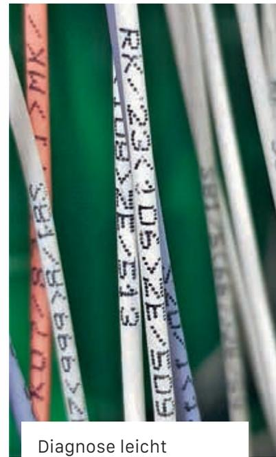
Diagnose leicht gemacht: Alle Informationen über Controller- und PIN-Belegung sind auf die Kabel aufgedruckt.
