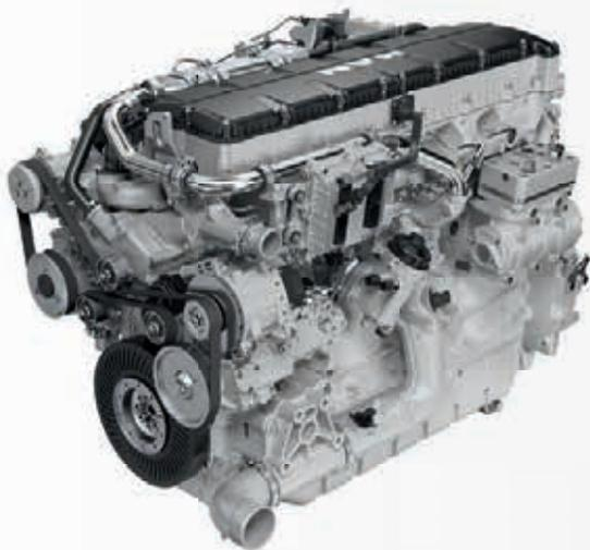
MAN 6-Zylinder-Reihenmotor **581 kW (790 PS)** mit 16,2 Liter Hubraum mit Common-Rail-Einspritzsystem, AdBlue, SCR-Kat und Abgasrückführung.
