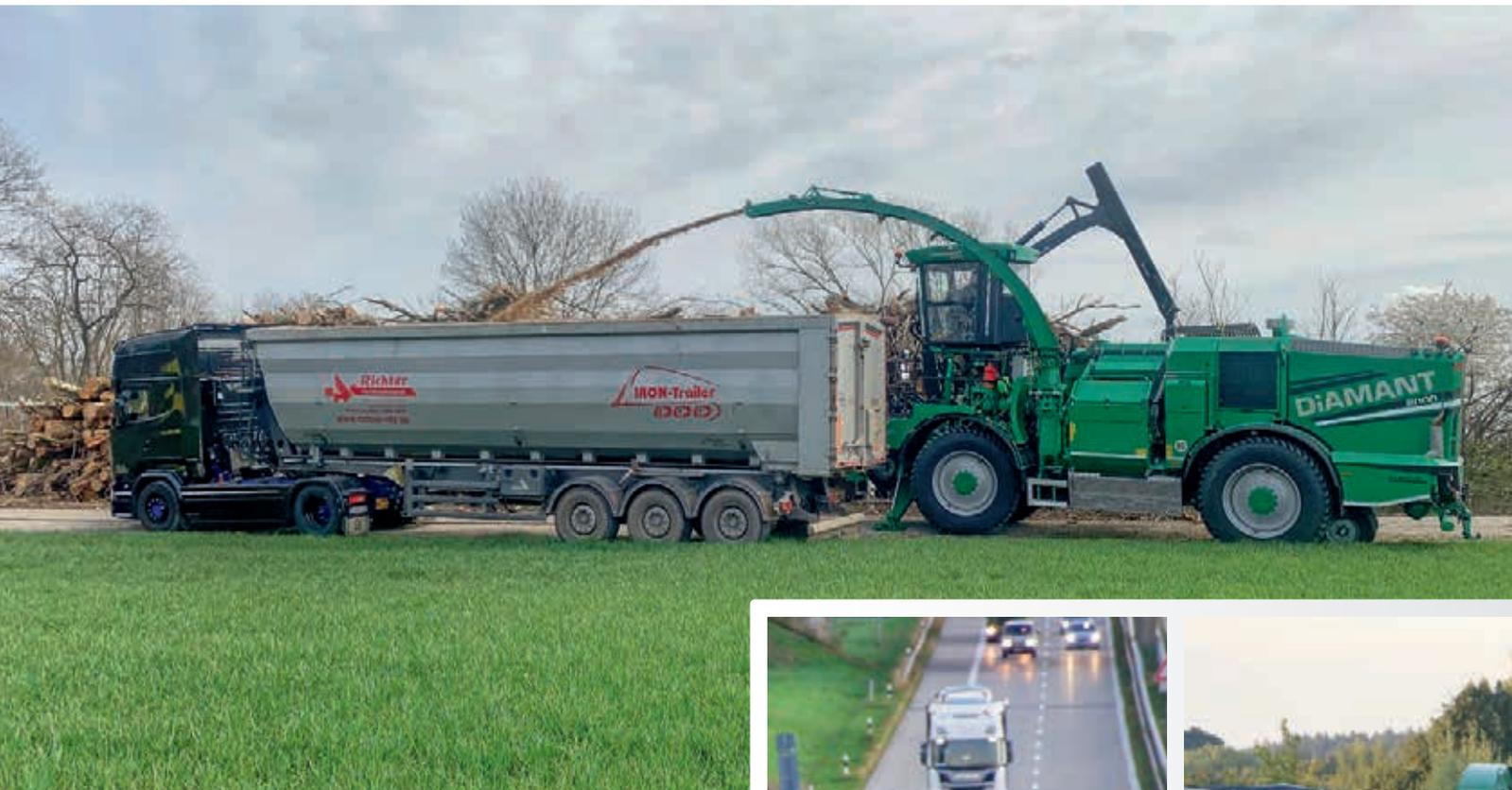
Durch das **permanente Allradsystem** mit unabhängigem hydromechanischen Antrieb an jeder Achse ist es ein Leichtes, Bergfahrten im unwegsamen Gelände zu meistern.
