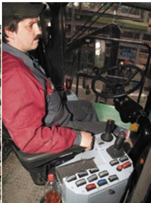
Der geräumige Fahrerstand ist um 180° drehbar und hält in jeder Position. Die beiden Joysticks besitzen alle zum Arbeiten wichtigen Funktionen.
