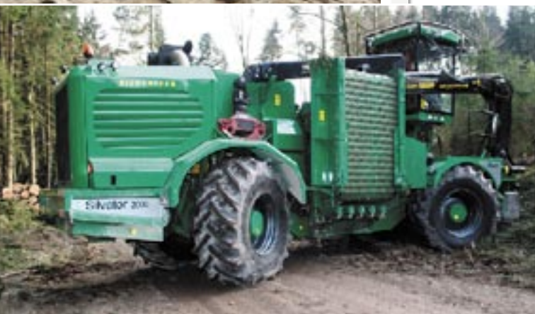
Dank verschiedener Lenkmodi ist selbst auf einem Waldweg eine Wendung möglich. Eine Rückfahrkamera fehlt allerdings noch.
