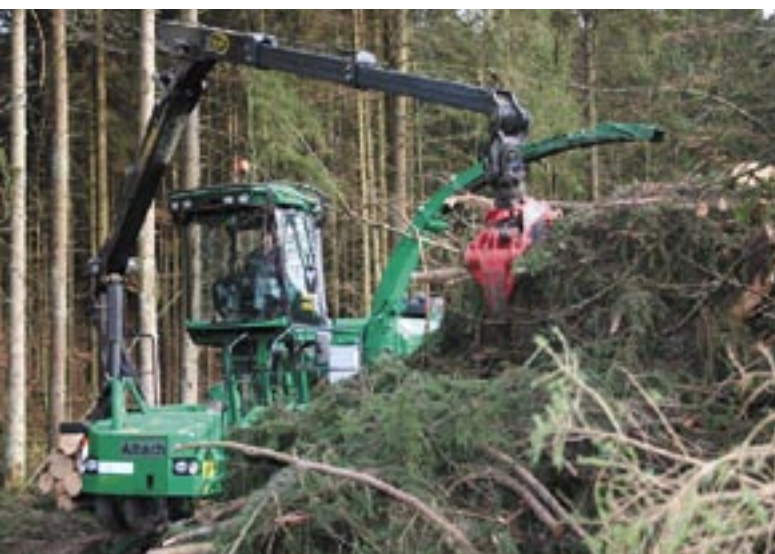
Der große Schwenkbereich des Krans erlaubt sogar das Aufladen von Haufen auf der anderen Straßenseite.
