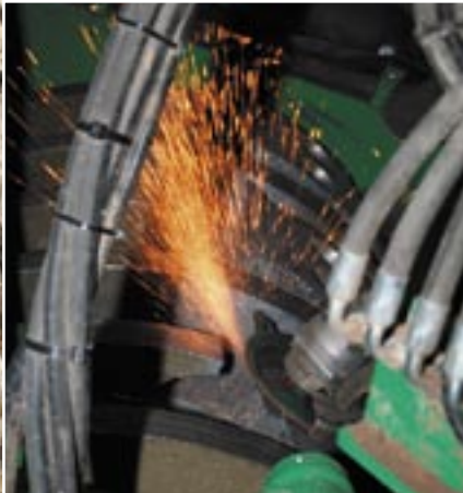
Die 12 Messer der 4 t schweren Hacktrommel müssen bislang von Hand geschärft werden.
