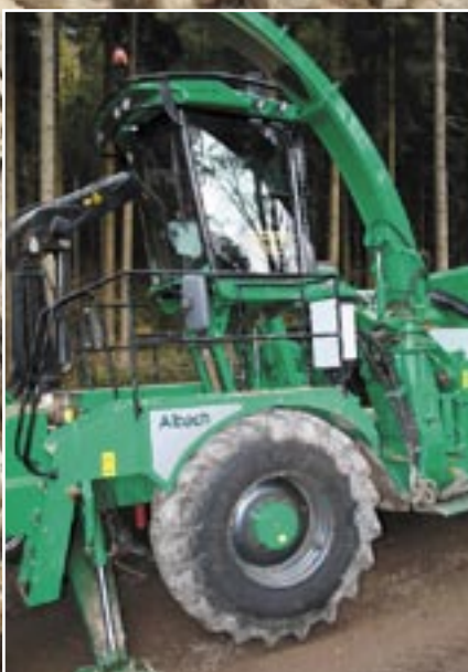
Damit der Fahrer sein Umfeld optimal sieht, kann die Kabine um 1,10 m hoch fahren. Die Stützfüße werden von einer Druckautomatik reguliert.
