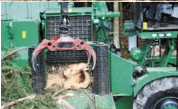
Das Stahlband vor der Hacktrommel wandert bei größeren Stücken bis 97 cm nach oben.
