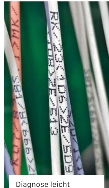
Diagnose leicht gemacht: Alle Informationen über Controller- und PIN-Belegung sind auf die Kabel aufgedruckt.
