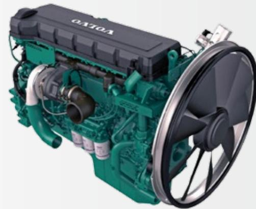
▲ Volvo 6-Zylinder-Reihenmotor (Tier 4) **515kW (700PS)** mit 16,1 Liter Hubraum, Pumpe-Düse-Einspritzsystem, AdBlue, SCR-Kat und Abgasrückführung.
